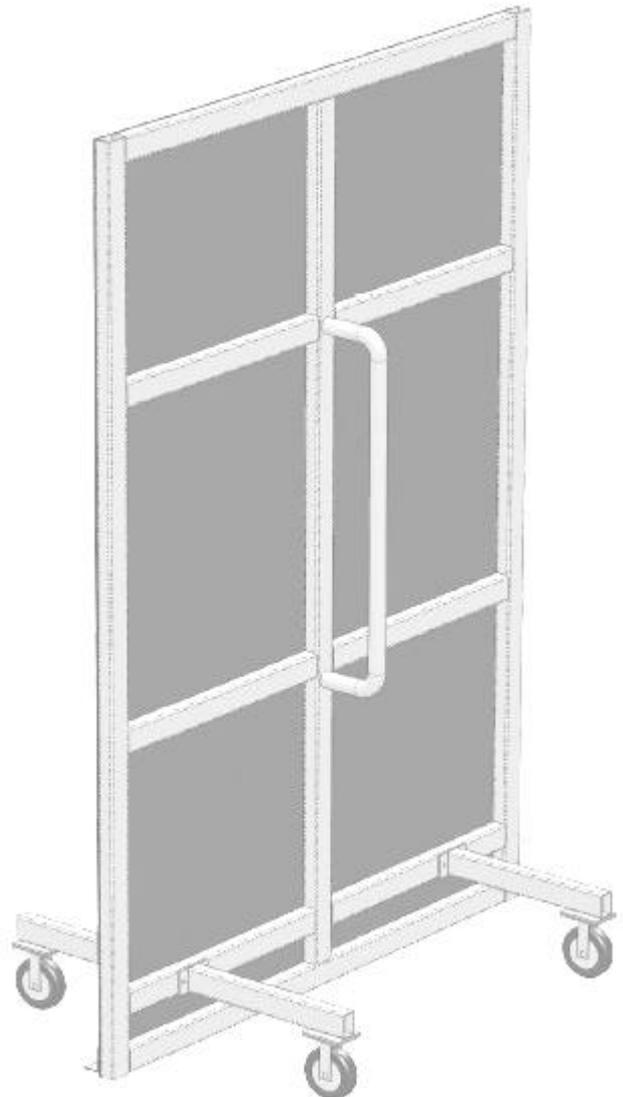
\* Durch ein verstellbares Ausgleichselement kann der Strahlenschutz nahezu vollständig bis zum Boden sichergestellt werden. Im „eingefahrenen“ Zustand stellen eventuelle Bodenunebenheiten beim innerbetrieblichen Transport keine Behinderung dar. Für zukünftige Strahlenschutzanforderungen mit höheren Abschirmwerten besteht die Möglichkeit, das Grundgerüst mit weiteren Sandwichelementen zu versehen.
